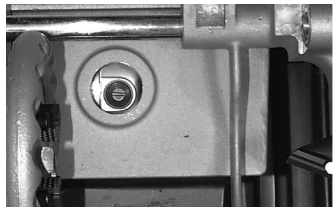
Figura 19 - Se ha extraído el tapón de la tapa de las escobillas en la carcasa y el sujetador de la escobilla ha quedado al descubierto
