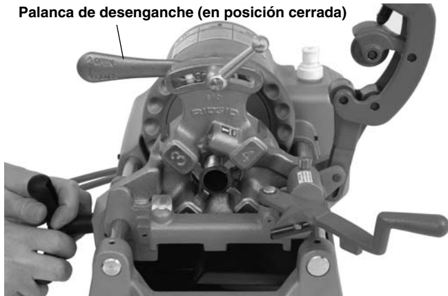
Figura 13 - Roscado de un tubo con el Cabezal de Terrajas No. 610
